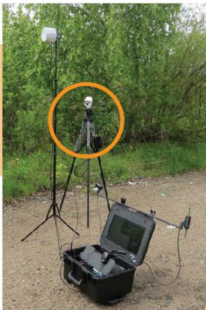
**Камера поворотная:** штатив с пузырьковым уровнем, средства энергообеспечения, камера с разрешением 720p, система дублирования видеопотока с камеры по каналу WiFi. Время работы от автономного источника питания – 2 ч.
